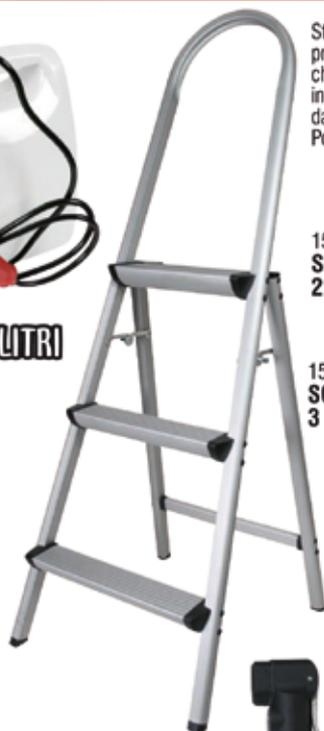
Struttura in alluminio, gradini profondità 75mm antiscivolo, chiusura di sicurezza contro incauta chiusura. Altezza guardacorpo da piattaforma 545mm. Portata massima 150kg.
