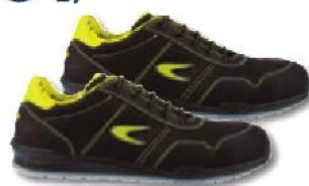
Scarpa bassa Coppi S3 SRC in nabuck idrorepellente, puntale in alluminio, lamina non metallica, colore Nero/Giallo, taglia 39 1287084
