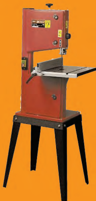
Cod: 41427 SEGA A NASTRO SN210P Altezza di taglio 100mm, profondità di taglio 245mm. Piano di lavoro in ghisa 340x340mm inclinabile 0-45°. Con squadre di guida rettilinea e goniometrica e piedistallo. Predisposizione aspirazione polveri. Sviluppo lama 1712mm.
