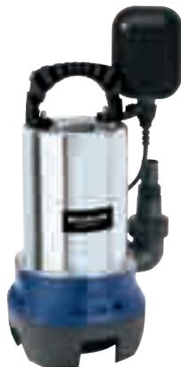
In acciaio. Potenza 630W. Prevalenza max 8 m. Portata max 17.000 l/h. Profondità immersione 5 m. Impurità fino a Ø 15 mm. Completa di cavo da 10 m e interruttore galleggiante
