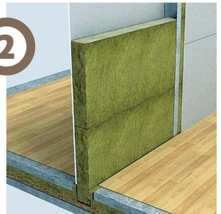
**L'isolamento delle pareti e del soffitto** è stato realizzato utilizzando un pannello in lana di roccia. Questi sono stati posizionati nelle intercapedini del tetto e delle pareti.
