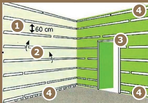
Il fissaggio delle perline ai listelli può essere fatto o mediante chiodatura (utilizzando chiodi senza testa) o con apposite clips da inserire nell'incastro della perlina (fissaggio invisibile).
