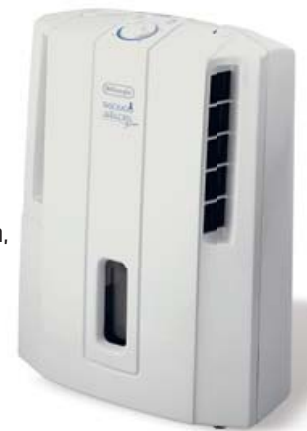
"DES12", capacità di deumidificazione lt 12/24 h, capacità serbatoio lt 3, rumorosità dB(A) 42, umidostato per regolare il grado di umidità desiderato nella stanza, cm L 37,5 x P 19 x H 48,5 cod 4212171 € 219,00
