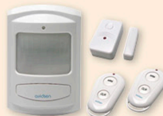
Kit allarme con combinatore telefonico GSM, 2 telecomandi e contatto magnetico. Il sensore infrarossi ha un campo d'azione di 110° in orizzontale e 90° in verticale e rileva i movimenti fino a 10 metri di distanza.
