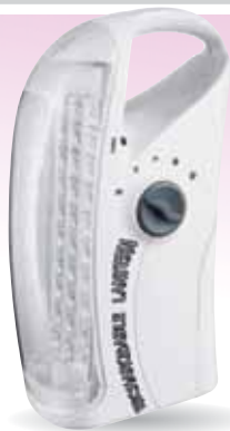
Lanterna d'emergenza 30 LED alimentazione V 220-240, tempo di ricarica 16-24 ore, batteria V 6, 4 Ah, autonomia 10 LED, W 0,6, 200 ore e 30 LED, W 1,88, 80 ore
