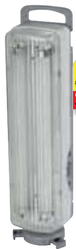
PLAFONIERA D'EMERGENZA PORTATILE a base girevole ricaricabile, alimentazione 220, tempo di ricarica 16-24 ORE, batteria 6V-4AH, 2 tubi fluorescenti da 10W, autonomia 1 tubo 10W 5 ore - 2 tubi 20W 3 ore
