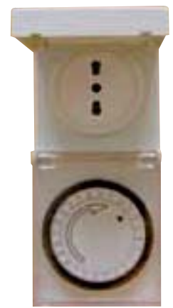
PROGRAMMATORE MECCANICO GIORNALIERO per esterno, grado di protezione IP44, presa 10/16 A, spina 16A, potenza prelevabile max 3500W
