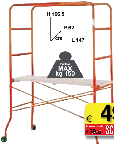
TRABATTELO IN ACCIAIO maggiore robustezza, tubi spessorati, H cm 166,5, piano di lavoro rinforzato altezza cm 120, altezza di lavoro cm 300
