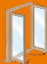
Attraverso il calcolo della trasmittanza termica (che è il flusso di calore espresso in Watt che passa attraverso 1 m<sup>2</sup> di parete nell'unità di tempo per ogni grado Kelvin di differenza di temperatura fra due superfici) è possibile classificare ogni componente edilizio indicandone un valore caratteristico U.
