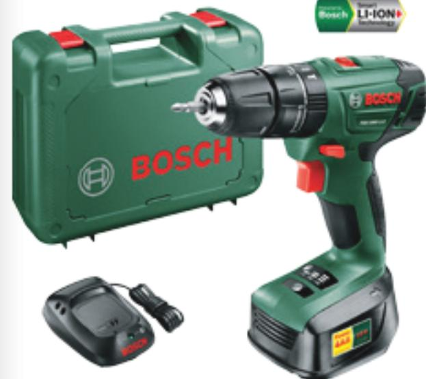
mod. PSR 14.4 LI, 1.3 Ah, mandrino autoserrante, preselezione della coppia di serraggio con 20 posizioni di regolazione, velocità a vuoto: 0-700 giri/min, coppia max di serraggio 34 NM, munita di batteria. In dotazione: 2 batterie, valigetta
